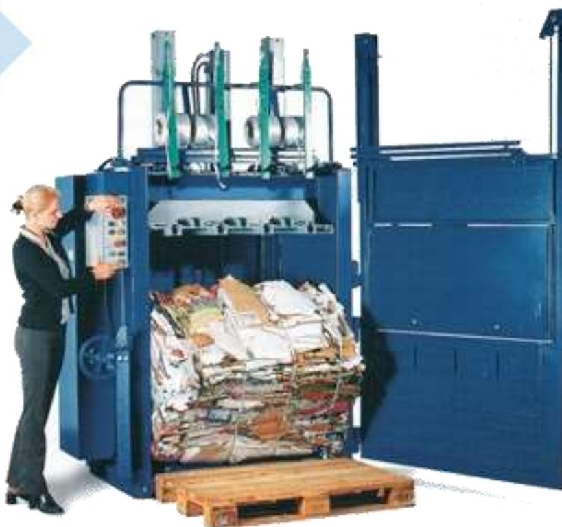
Прессы различают пакетировочные и брикетировочные, которые, в свою очередь, имеют вертикальный или горизонтальный тип загрузки. Вертикальные прессы чаще всего устанавливаются на предприятиях и в торговых центрах, так как они более компактны. А горизонтальные станки предназначены для больших заводов.
